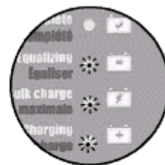
Figure 5 : Le mode égalisation a été mis en marche.
